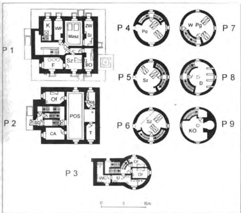
Plan poszczególnych kondygnacji wieży kierowania ogniem baterii „Schleswig Holstein”.
